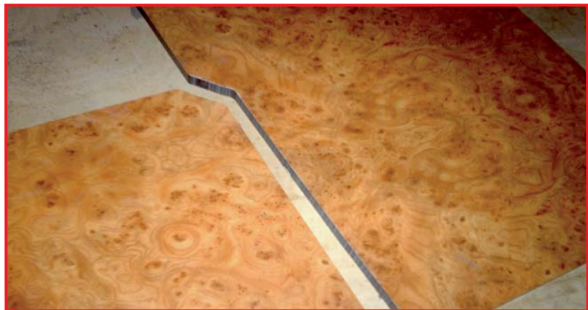
Detalle del corte con Fresa para la unión en "L"
