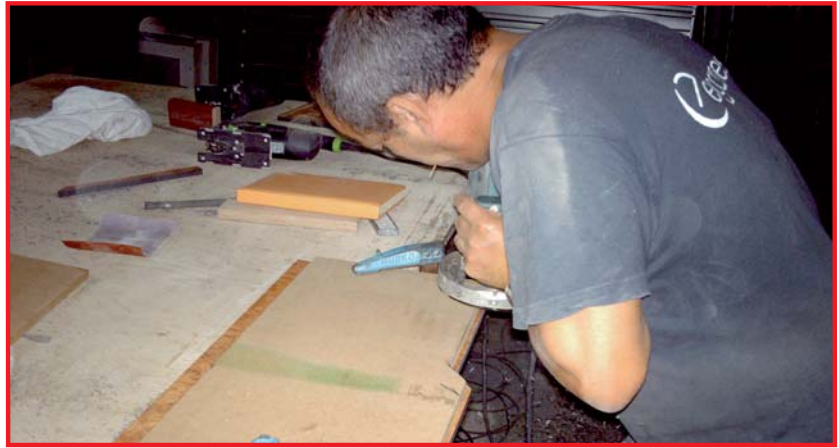
Detalle del corte con Fresa para la unión en "L"
