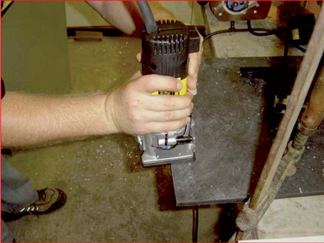
Detalle de proceso de biselado
